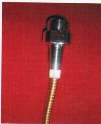
十五、将吸管与安装好的下阀体拼紧，下阀体组装完毕。
