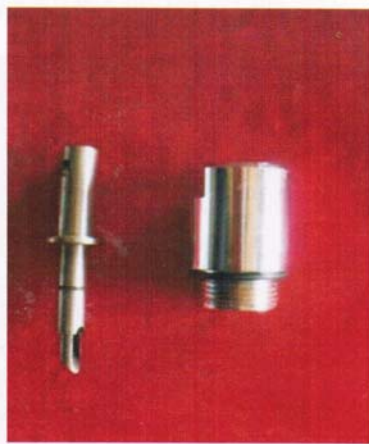
二、分别将 \Phi 8 \times 1 密封圈装入撞针上槽中、 \Phi 25 \times 1.9 密封圈装入弹力座上，装配过程中不得损伤密封圈。
