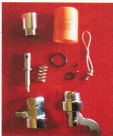
一、上阀体装配备件：保护套、上阀体、弹力座、撞针、不锈钢弹簧、操作头组件、密封圈（ \Phi 14 \times 2 、 \Phi 8 \times 1 、 \Phi 25 \times 1.9 ）、不锈钢珠、复位工具。
