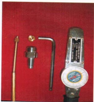
十二、下阀体装配备件：下阀体、安全螺塞、吸管、扭力扳手、10mm 对边六角扳手。
