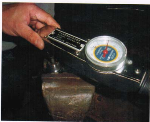
十四、将下阀体固定住，用扭力扳手下阀体螺塞内，用 50 至 60N.m 的力将螺塞与下阀体拼紧。
